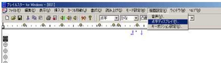
点字ディスプレイの機種を “ パワーブレイル 40 ” に設定します。出力先はドライバインストール時に作成された COM を選択してください。通信速度は “ 9600 ” に設定してください。
