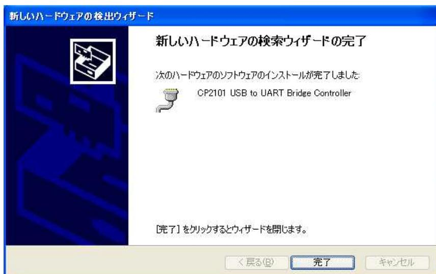
ドライバのインストールが完了しますと、シリアルポートが作成されていますので、何番の COM ポートが作成されているか確認しておきます。確認方法はコントロールパネル - システム - ハードウェア - デバイスマネージャを開き、ポートの“CP2101 USB to UART Bridge Controller”の COM 番号を確認します。
